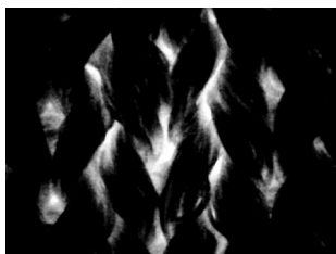
图 2 涤锦复合丝织物碱减量后 200 倍电子显微镜照片
