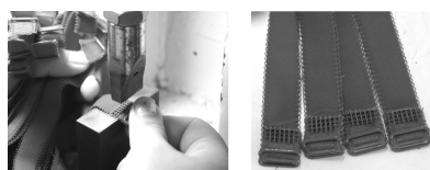
(a)操作示意图 (b)黏结后的肩带 图2 超声波黏结肩带
