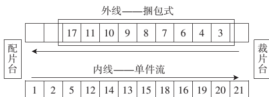
图7 生产线布局及物流路线图(改善后)
