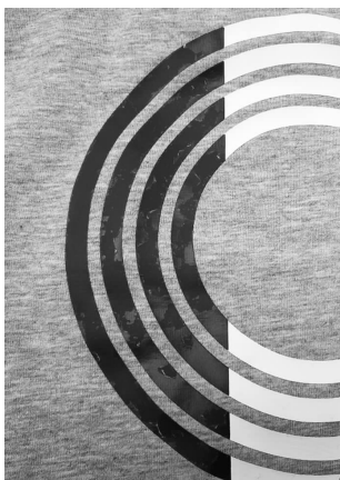
图4 覆膜脱落印花图样
